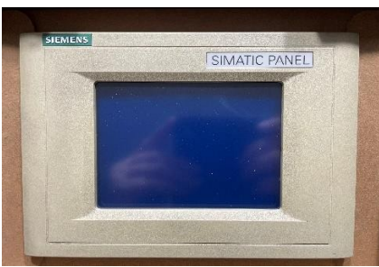
Panel Siemens po výměně dotykového skla.
