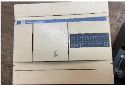
Průmyslový automat (PLC) Telemecanique.
